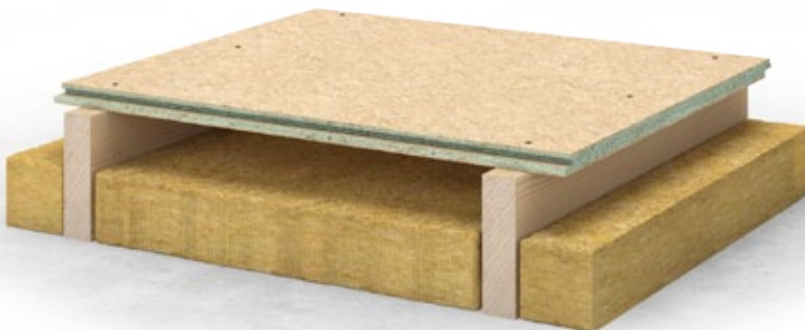
2. Укладкам с использованием минеральной ваты или пенополистерола
