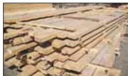
– **Доска обрезная** для устройства опалубки 40(50)х100
